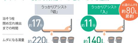
※試験条件: 沸湯はり設定180L 機種: HE-WUJ7LQS 動水圧: 0.3MPa 浴そり: 1.0坪仕様(1380mm×680mm×450mm)
