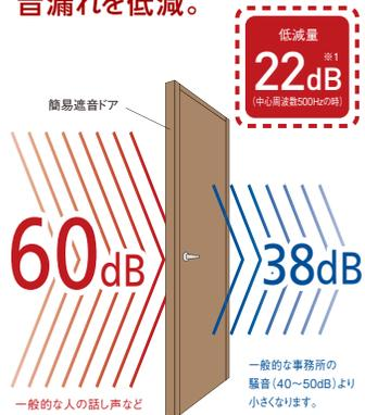
※1.JIS A 1416(実験室における建築物材の空気音遮断性能の測定方法)に基づいた音響透過損失の当社実数値になります。実際の現場では構造や環境等の条件により異なりますが、実際の空間による音の吸収を踏まえると25dB程度(中心周波数500Hz時)の遮音性能が見込めます。
