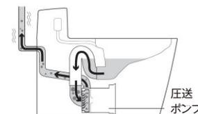
汚物を粉碎し、押し流すため洗浄時に大きな音が出ます。
