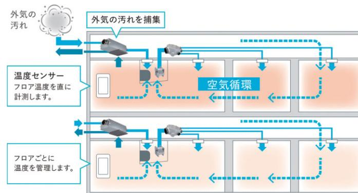
ダクト式熱交換気の途中にルームエアコン(空調ユニット)をプラスすることで全館空調が完成。冷暖房された空気が各部屋に送られ循環するため、部屋ごとの温度差が少なく、フロアじゅう心地よい温度に。外気を取り込む際も気になる汚れを捕集し、24時間新鮮で澄みやかな空気を送ります。
